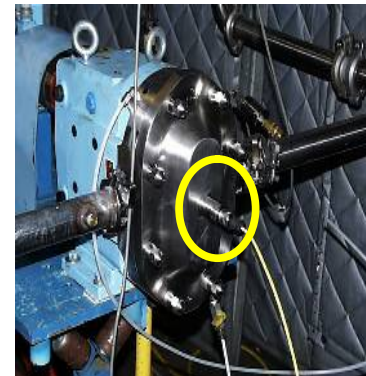
ポンプの中心にPC420ATP-05-B3223センサーを取り付け
